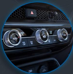
Climatizador digital con función de ajuste automático de temperatura.
